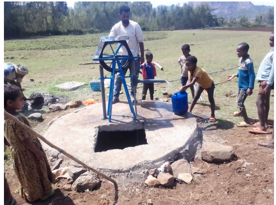
Dank gestiegenem Grundwasserspiegel kann mit sogenannten "Rope-Wasserpumpen" Wasser hochgepumpt werden.
